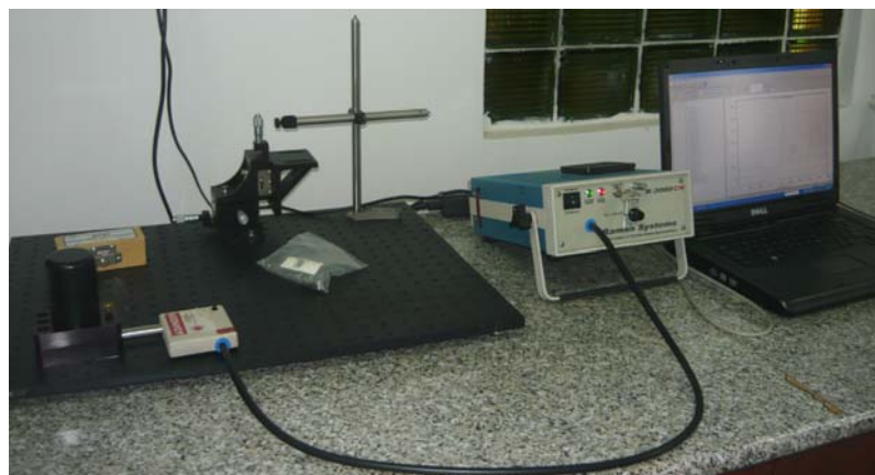
Fig. 3 Imaginea fotografica a spectrometrului Raman portabil
